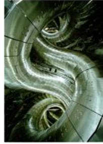
我が国独自のアイデアに基づく超伝導コイルを用いた世界最大のヘリカル型実験装置「大型ヘリカル装置(LHD)」により、高温高密度プラズマの実現と定常運転の実証を目指す。
