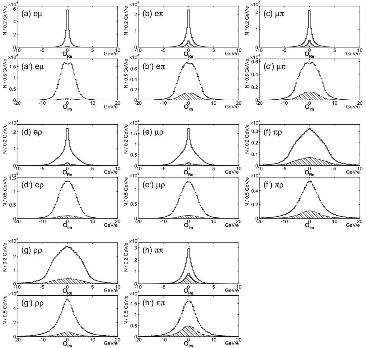
図 7: Optimal observables  $\mathcal{O}_{Re}$  と  $\mathcal{O}_{Im}$  の分布。データを黒丸で、MC をヒストグラムで示す。
