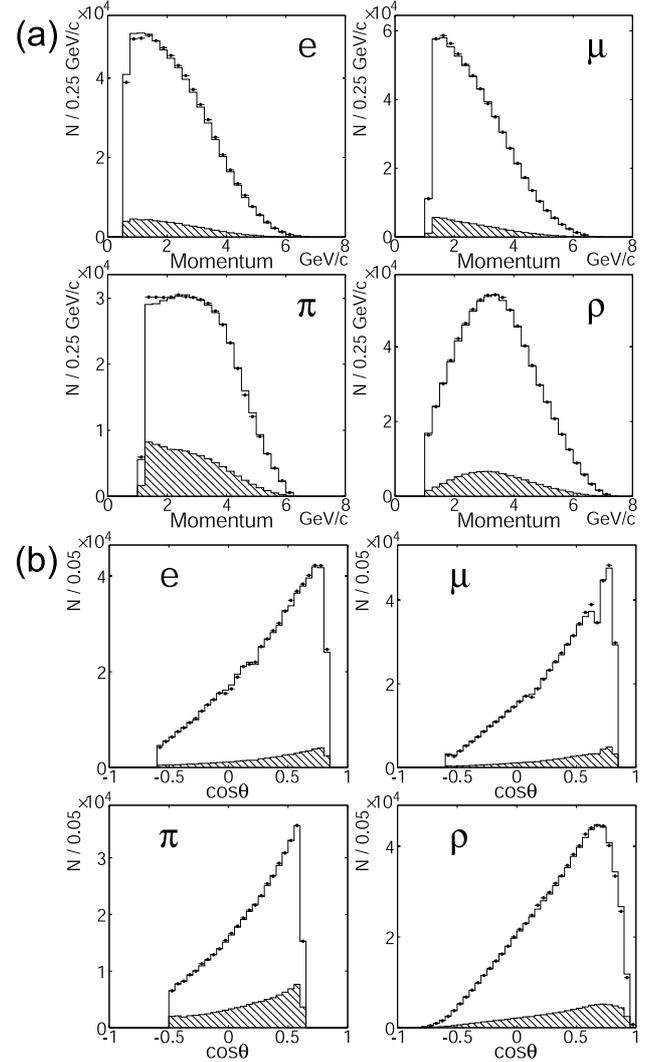
図 6: 信号事象の (a) 運動量と (b) 角度分布。モンテカルロ・シミュレーション分布をヒストグラムで、その中の BG は灰色のヒストグラムで示し、データは黒丸で示す。
