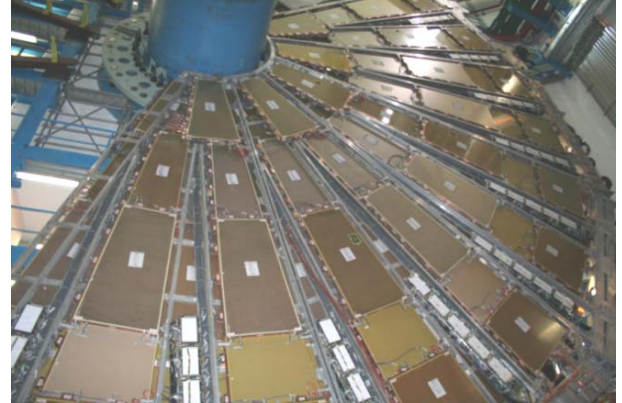
図 10: 現在、ATLAS 地下ホールにおいて TGC の建設が進んでいる。
