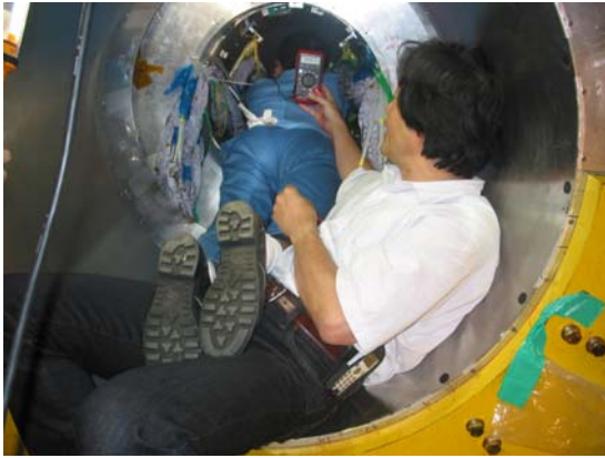
図 5: Belle の一番内側にある SVD 検出器のインストール時の風景。衝突点ビームパイプと検出器のグラウンドが電氣的に接触していないことを確認している。
