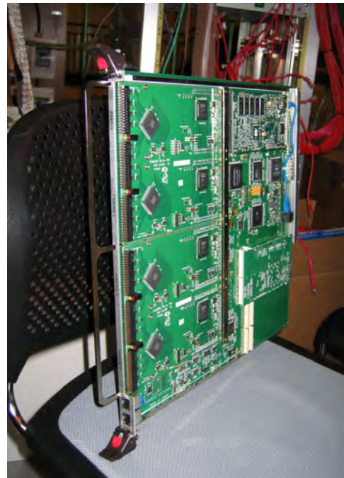
図1：Belle DAQ のパイプライン化に用いた COPPER-TDC モジュール
