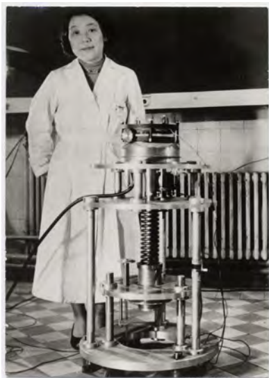
図5 自ら開発したサイクロトロンに直結して用いる圧力可変・自動(および自記)ウィルソン霧箱とともに(1957年)
