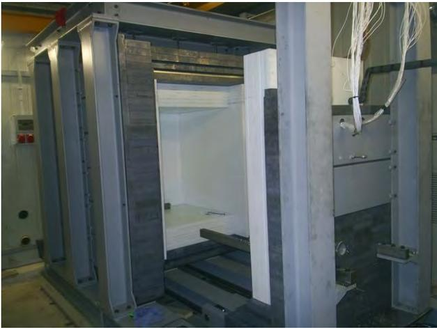
図 2 グランサッソに設置された XENON10 のシールド内側ポリエチレン 20 cm は高速中性子のため, さらに鉛 20 cm で外から来るガンマ線を防ぐ。
