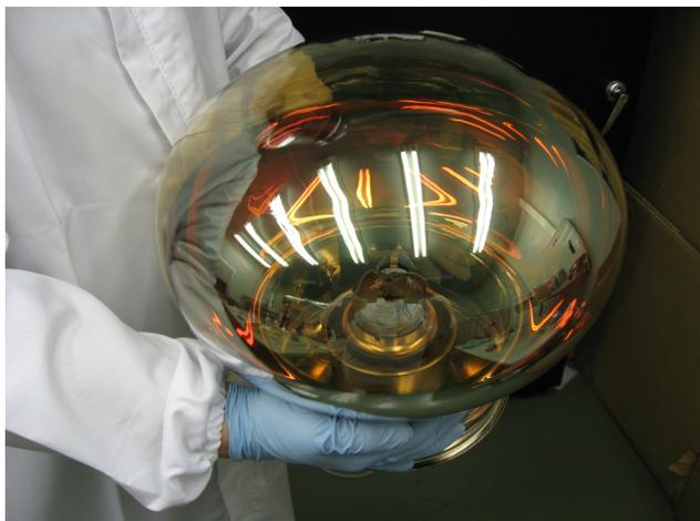
図 2 13 インチ HAPD 試作機
