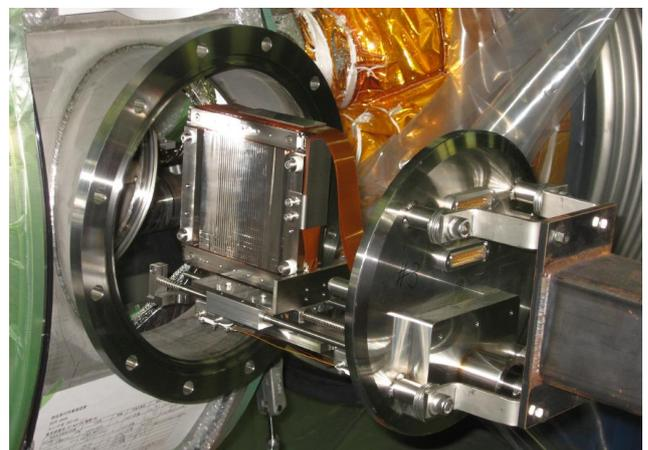
図 8 超伝導部の SSEM およびその駆動機構
