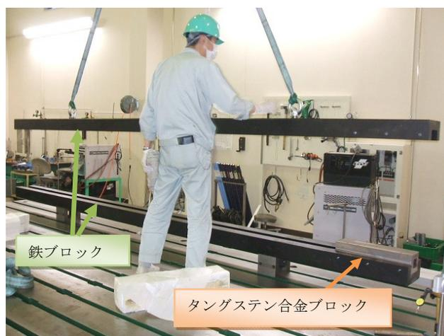
図6 コリメータの加工, 寸法検査, 組み立ての様子
