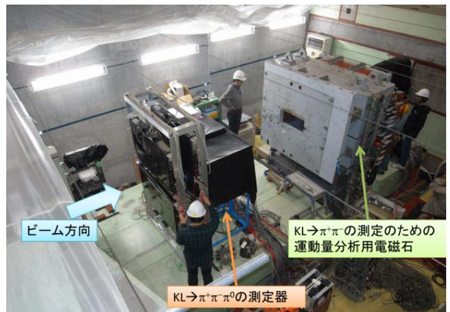
図10  $K_L$  粒子収量測定系の写真
