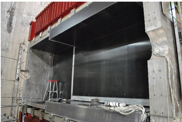
図7-1 2010年夏(8月時点)にマグネット内側に設置された直後のBarrel-ECAL
