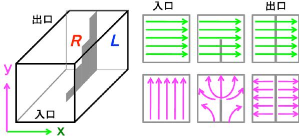
図 6. Septum polarizer の原理
