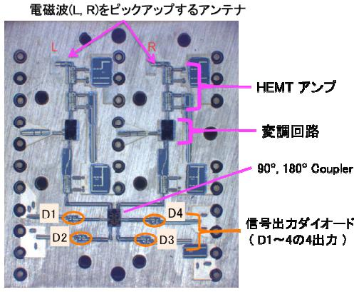
図 7. 95GHz 帯偏光モジュールの内部
