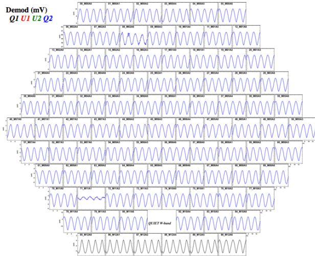
図 9. 観測サイトではじめて観測した全 90 モジュールの偏光信号出力。ワイヤーによってつくられた偏光信号を回転させることにより、検出信号はきれいなサインカーブを描く。
