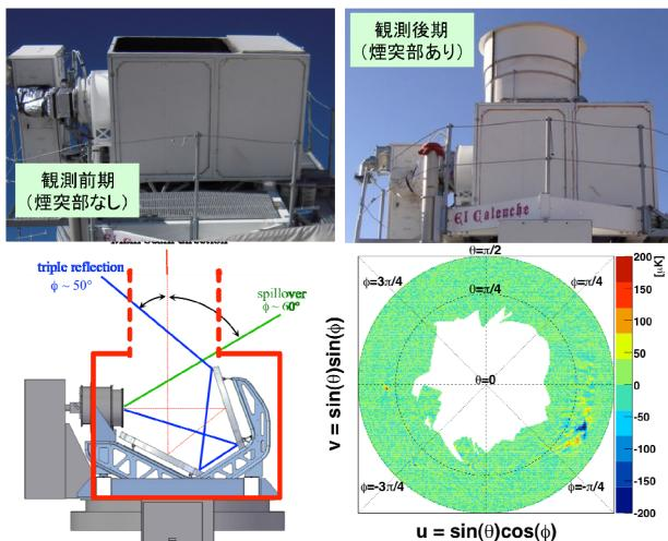
図 14. Far-sidelobe(左下に模式図)を遮断する「煙突部」の設置前後の写真(左上、右上)。太陽を使って、2つの方向からの far-sidelobe の特性を理解・確認した(右下、煙突部設置前のデータ)。
