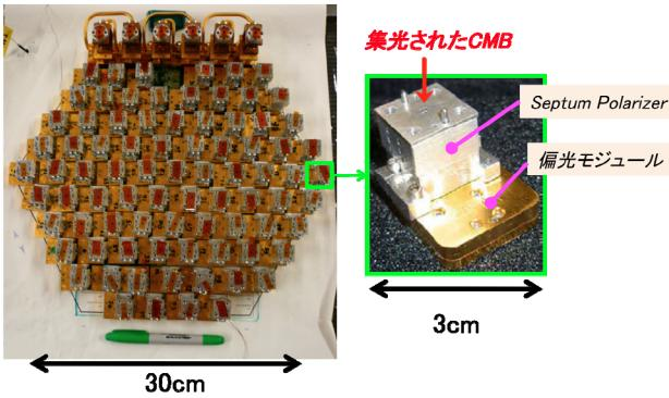
図4. 95GHz帯偏光検出器モジュール:90モジュール・アレイ(左)とモジュール一つの拡大写真(右)
