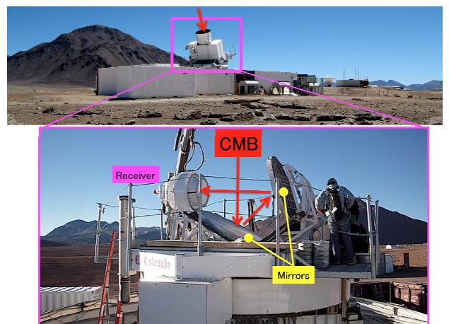
図3. QUIET望遠鏡の観測中の外観写真(上)と地面放射遮蔽用のシールドを取り外した望遠鏡内部の様子(下)
