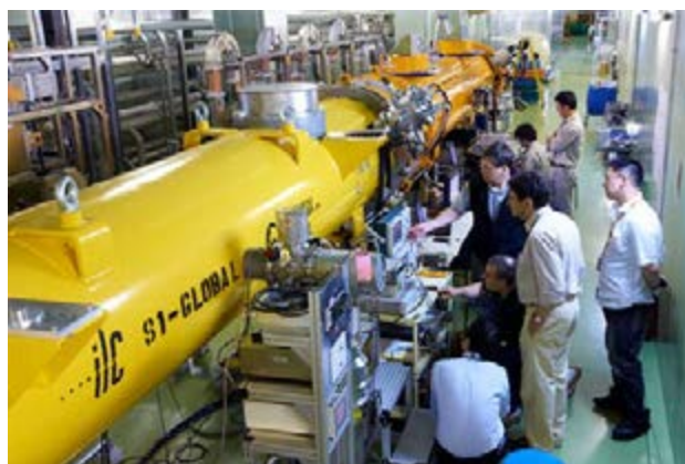
図2. 技術設計フェーズにおいて KEK がホストした国際クライオモジュール試験 (S1-Global) における実験の様子。
