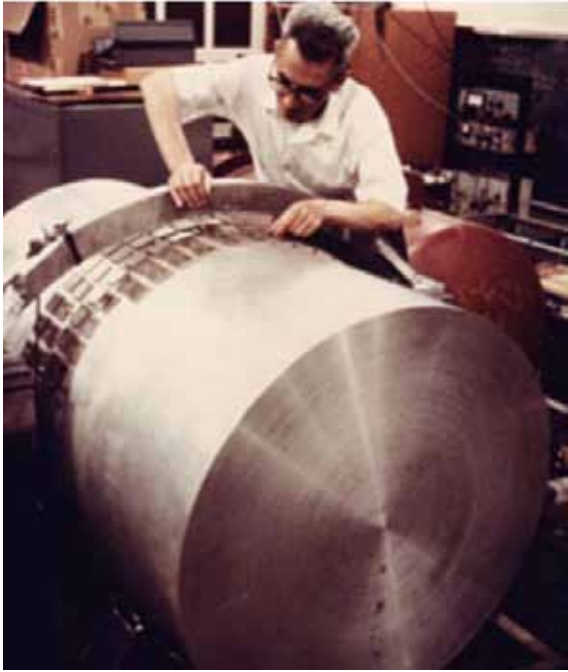
図 2. ウェーバーと共振型重力波検出器。 (AIP Emilio Segre Visual Archives)
