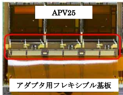
図7: APV25とアダプタ用フレキシブル基板のワイヤーボンディング結線箇所。図の枠線で囲まれた部分に APV25 とフレキシブル基板をつなぐワイヤーボン드가打たれる。
