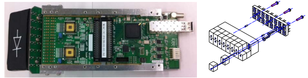
図5 Kalliope 1 ユニットの写真。右図はシンチブロック（写真左の黒）の内部構造。サイコロ状のシンチレータの集合体で、接着された波長変換ファイバの端面を 1.3mm 角の MPPC 光検出器が見込んでいる。
