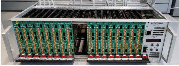
図 12: WaveDREAM を 16 ボード搭載したクレート。
