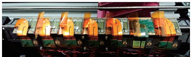
図 9: 実モジュールデモンストレータ。カーボンファイバ製の構造体にフレキ基板が接着されたピクセルモジュールをインストールした。右から二番目を除く 6 台のモジュールに搭載されているフレキ基板は日本製で, 左の二台には浜松ホトニクス社製のモジュールが使われている。
