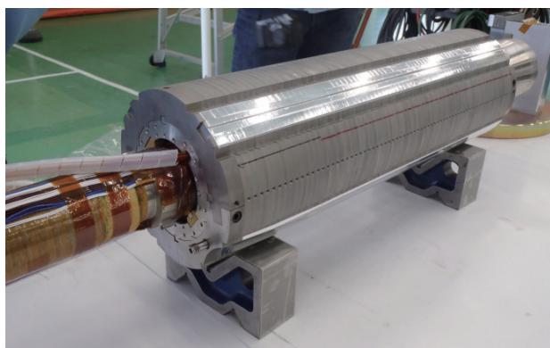
図 7 QC1LE 超伝導 4 極電磁石。4 極磁石はクライオスタット内筒に固定され、内筒表面には 4 台の超伝導補正磁石が取付けられている。
