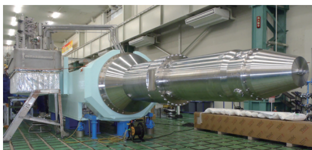
図 16 QCS-R クライオスタット(製作会社工場内での組立風景)
