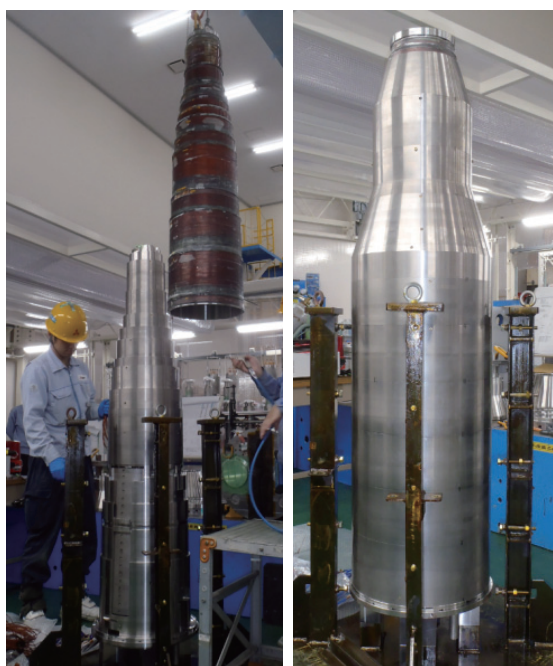
図 15 QCS-R IP 側超伝導電磁石と ESR1 の組合せ(左図)と ESR1 外周部に W 放射線シールドを取付けた状態(右図)
