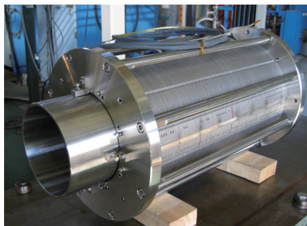
図 2 KEKB アップグレード用に開発された R&D 超伝導 4 極電磁石
