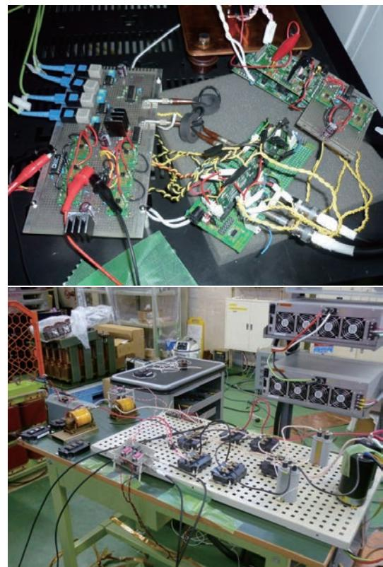
図 8: 開発当初の実験セットアップ。上は制御システムで左上が AD ボードで真ん中が DSP ボード（どちらも評価ボード）。下はジャンク品ボードから外した IGBT（点在している黒いもの）を配線して作った電力変換器。
