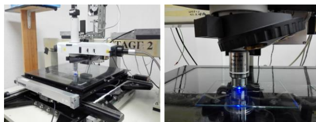
図 10 現在運用中のサブミクロン飛跡自動読み取り用システム PTS.2 (左図:全体像,右図:読み取り中の対物レンズおよび NIT フィルム)。
