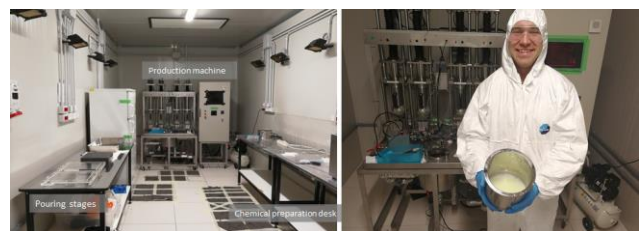
図 16 グランサツ研究所の地下実験施設 (Hall.F) に建設されたデバイス製造ファシリティ(左)および最初のデバイス製造テストの様子(右)
