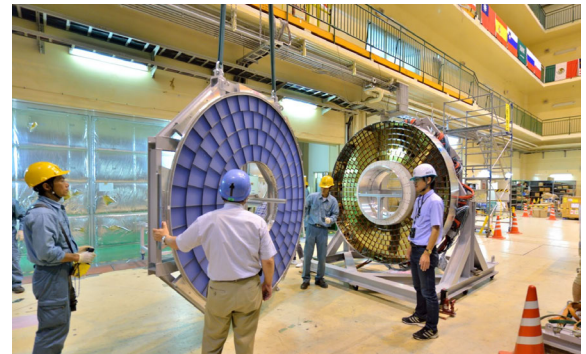
図 7: ARICH 検出器のエアロゲル側と HAPD 側の合体の様子。
