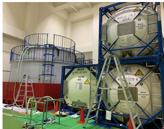
図 8: 配管を連結して充填する際の写真。ISO-tank が右手に、検出器が奥に見える。
