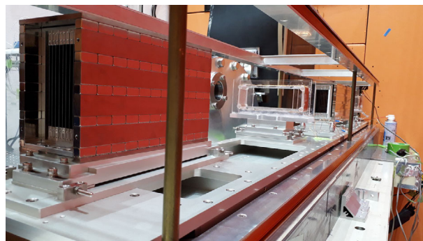
図 9: ビームラインに新たに設置された大型 SFC。磁気スーパーミラー（手前）とスピン反転用のコイル（中央）がスピン保持用のガイドコイル中に設置されている。
