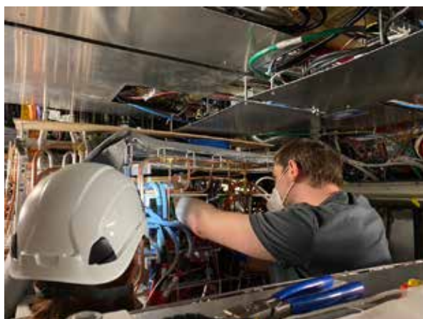
図 13: 中継ボードの取り替え。ケーブルの海をかき分け 10 年以上刺さって周りと融合したボードを叫びながら引き抜く。
