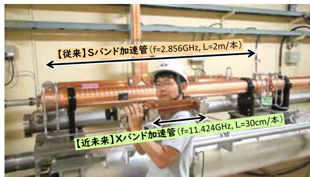
図 1: KEK 電子陽電子入射器の地下トンネル内にて撮影。S バンド加速管は、実際に加速器の運転で使用しているもの。その前で著者が担いでいるのは、CLIC 用 X バンド加速管。どちらも 1 本で 40 MeV (定格) 加速する。
