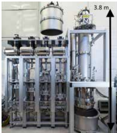
図 5: ラドン蒸留装置 [13]。右側が蒸留塔本体，左側が高流量・低ラドン放出ガスキセノンポンプ。
