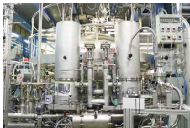
図 4: 液体キセノン純化システム。中央二つの真空容器に純化フィルターが、中央下の容器には純度モニターが収められている。
