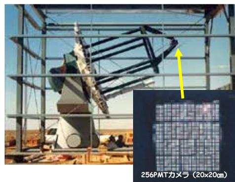
図 1 豪州ウーメラに建設中の 3.8 m 径 TeV  $\gamma$  線望遠鏡とその焦点に付けた 256 PMT カメラ
