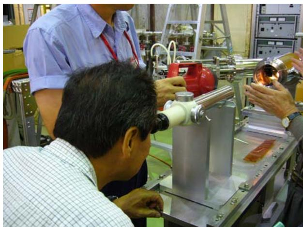
図 14. アラインメント用テレスコープにより標的の傾きを計測している様子
