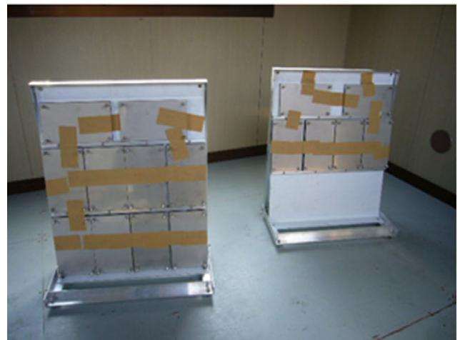
図 5 北海道、昭和新山のミュオグラフィ観測で用いられた原子核乾板
