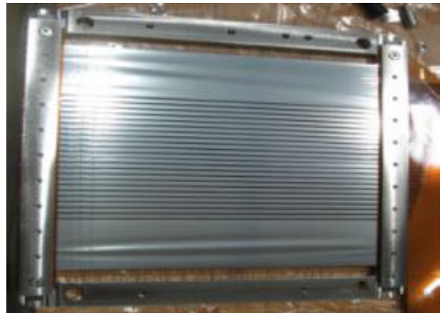
図 8 SSEM の写真。SSEM は“strip”と呼ばれる厚さ 5 \mu s、幅 3.5 mm~5.0 mm の Ti ホイルが 24 本並んだ構造になっている。
