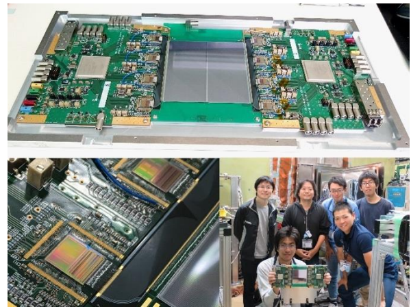
図 6 組み立てた検出器モジュール(上)と ASIC 周りの拡大図(左下)、 2017 年 6 月の MuSEUM 実験のビームテストの集合写真(右下)。
