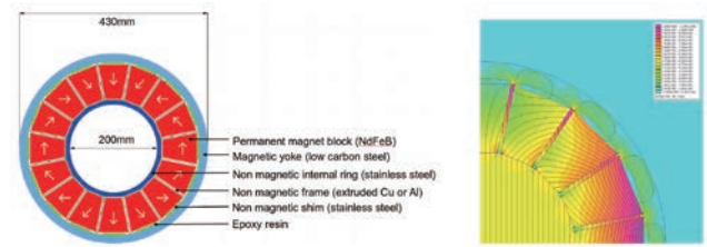
図 13: 永久ダイポール磁石の概念図 (左) と磁場構造 (右)。左図で、矢印は各ハルバッハ配列の磁場の向きを表す。
