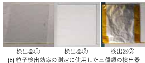
図 5: (a) 粒子検出効率測定のセットアップ。SiPM は右下に示すベージュ色のフレームに入れ、灰色のフレームの側面に固定した。(b) 測定に使用した三種類の検出器。左から、加工を施していない物、タイル表面に拡散型反射塗料を塗った物、タイルをアルミホイルで包んだ物。
